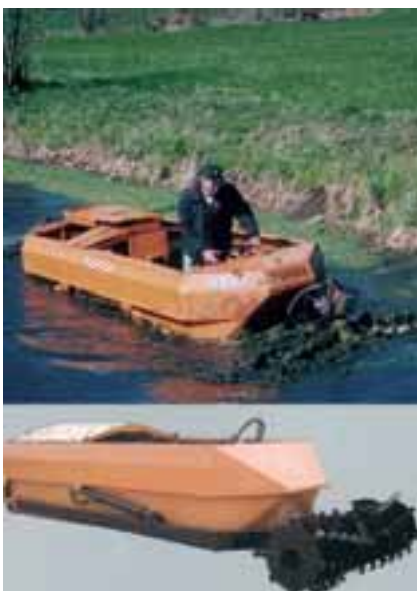
Båt med frontmonterad rotkultivator för vegetationsbekämpning i sjöar och vattendrag.
